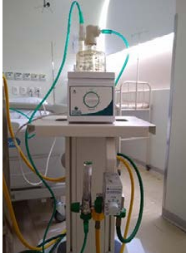
Desenvolvimento de blender de O2 para garantir controle adequado de temperatura e umidificação de oxigênio para pacientes internados nas UTIs Neonatal e Pediátrica
